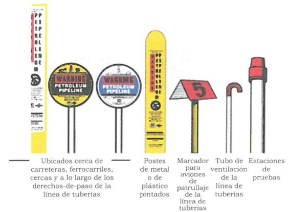
Ubicados cerca de carreteras, ferrocarriles, cercas y a lo largo de los derechos-de-paso de la línea de tuberías
